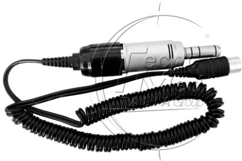
Micromotore elettrico Tecnomed Italia. Velocità max 35.000rpm, universale a spazzole, e-type, cordone spiralato
