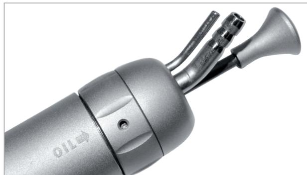
Lo sganciamento della fresa avviene attraverso un meccanismo semplice e sicuro, premendo il pulsante posto nell'attacco del manipolo. Grazie a questo innovativo meccanismo non sono presenti fastidiose e antigieniche viti esterne per il bloccaggio della fresa. Ruotando la ghiera posta alla base del manipolo si accede al foro di lubrificazione senza la necessità di scollegare i tubi di alimentazione.
